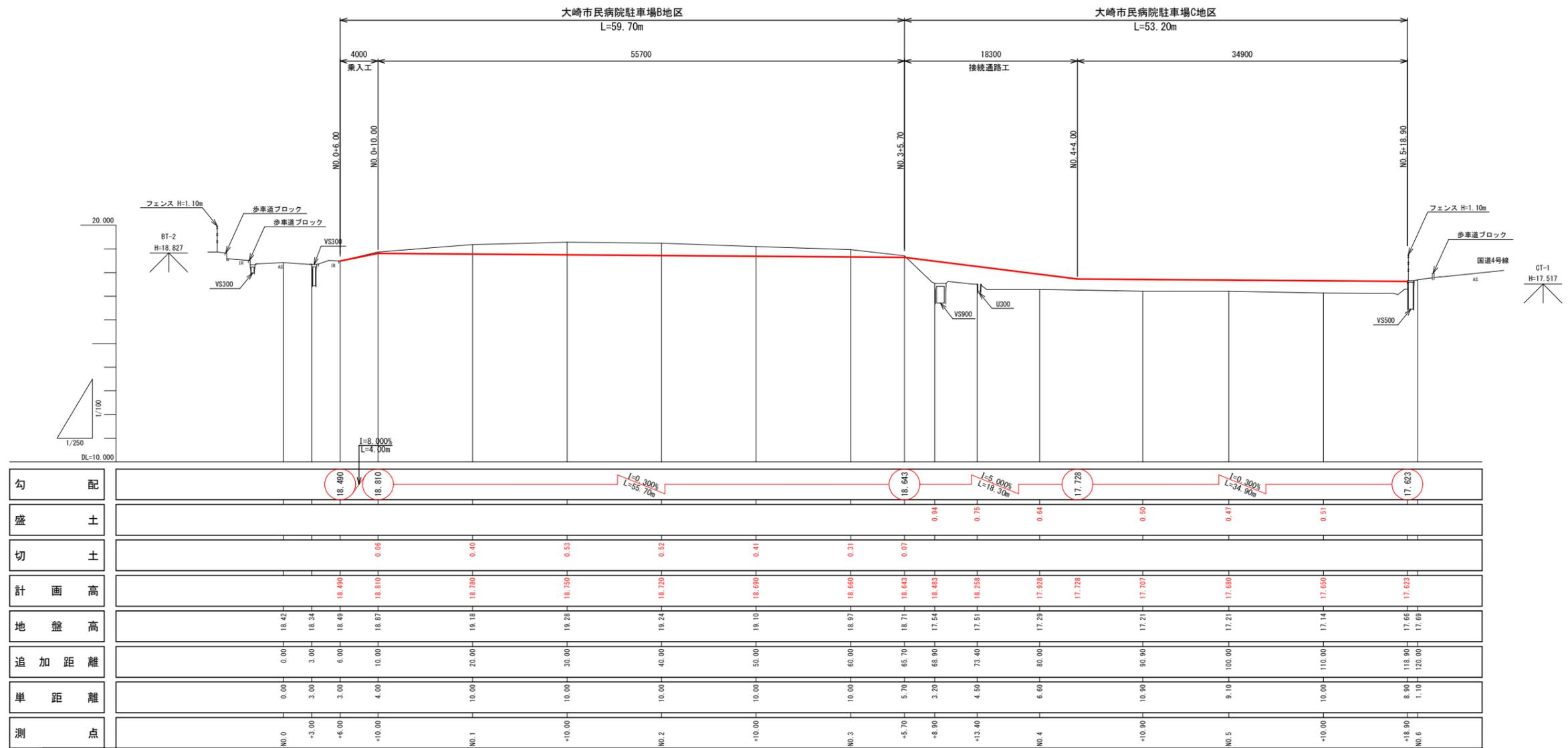
※本業務の高さの基準は、GNSS測量により付与した標高値を基準としたため、任意標高として扱う。
