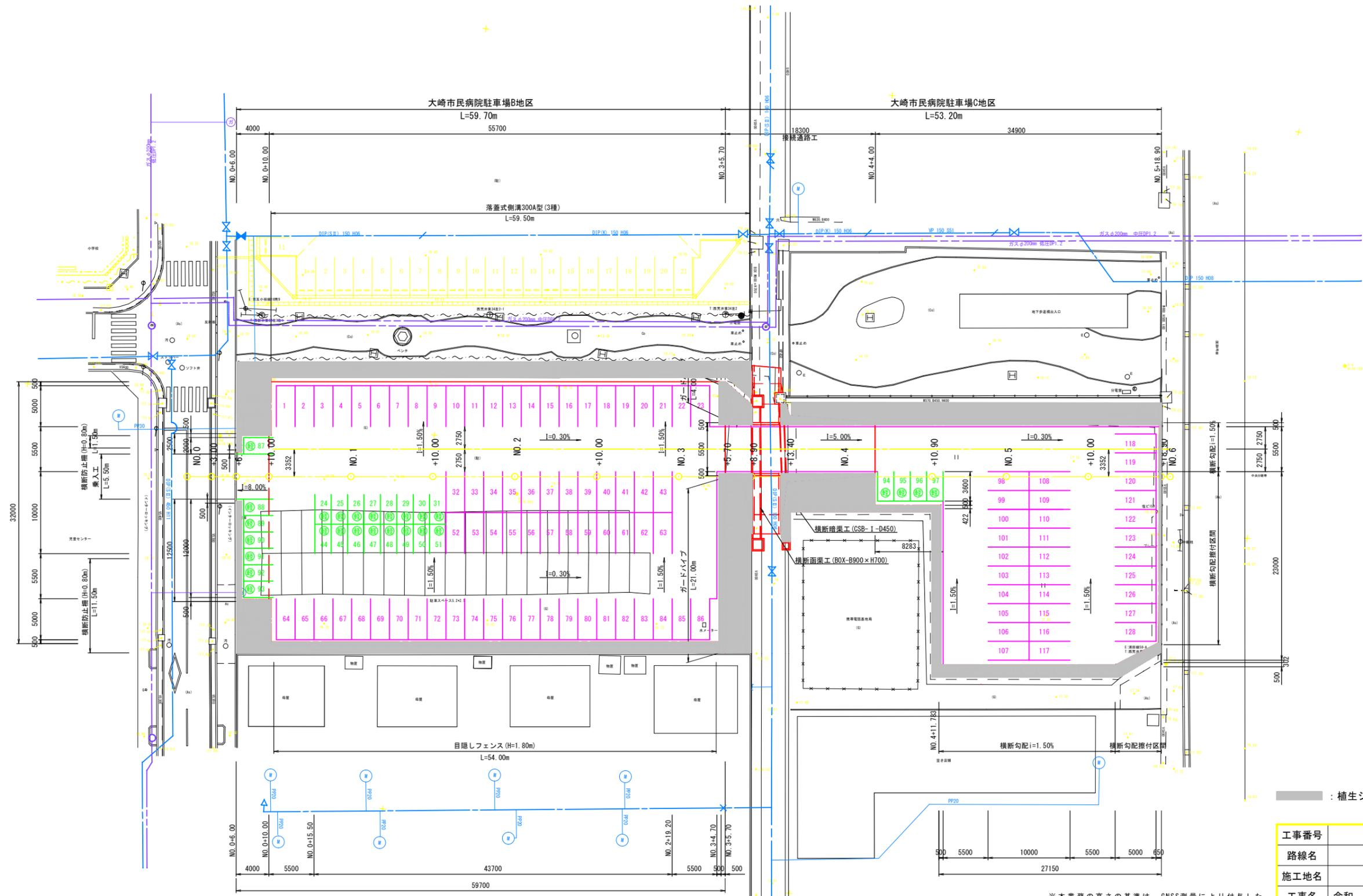
※本業務の高さの基準は、GNSS測量により付与した標高値を基準としたため、任意標高として扱う。
